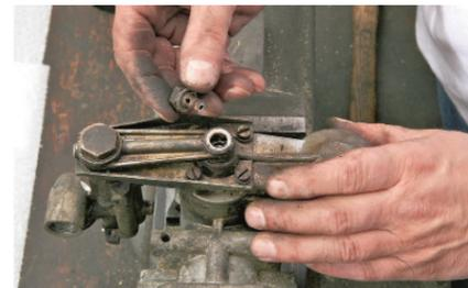
Und ab dafür: Die Hohlsschraube der Spritzzufuhr zum Startvergaser reißt fast immer ab
