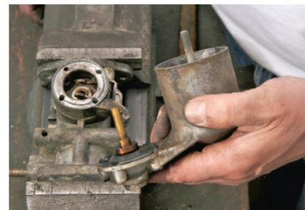
Kennzeichen der HD-Vergaser: Das Schwimmergehäuse ist mit vier Schrauben befestigt
