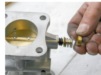
Ausgebucht und neu abgedichtet: die Lagerung der Welle im Vergasergehäuse
