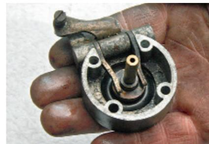
Oben im Bild: Die Einstellschraube fürs Gemisch. Sie regelt über eine Wippe die Position der Düse
