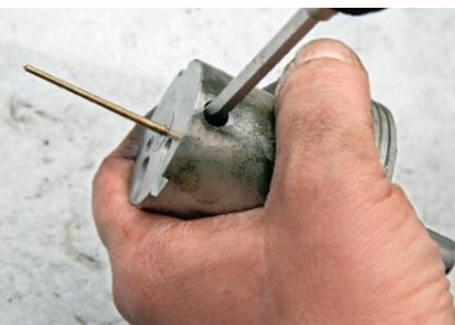
Ausschlaggebend fürs Gemisch: die im Vergaserkolben montierte Düsenadel
