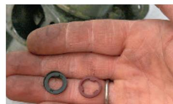
Fehler gefunden – binnen 30 Sekunden: Eine falsche und eine fehlende Dichtung sorgten für Überdruck in den Schwimmerkammern. Korrekt ist das rotbraune Teil. Manchmal ist auch eine falsche Flanschdichtung montiert, die einen Kanal verschließt – nicht so in unserem aktuellen Fall (I.)
